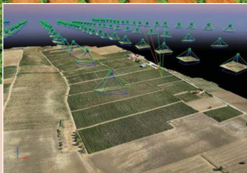
Εικόνα 1. Κτήμα Γεροβασιλείου: Τρισδιάστατο νέφος σημείων (point cloud), από το οποίο προκύπτει η καθ' ύψος πληροφορία και το μοντέλο εδάφους. Οι αιωρούμενοι κώνοι αναπαριστούν σημεία λήψης των επιμέρους φωτογραφιών που ελήφθησαν και χρησιμοποιήθηκαν για την κατασκευή του ορθοφωτοχάρτη.
